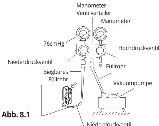
1. Schließen Sie das Füllrohr der Manometer-Ventilverteiler an die Wartungsklappe am Niederdruckventil der Außeneinheit an.
