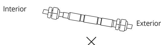
Infasurati sistemul de protectie anti-soc din cauciuc, la exteriorul regulatorului, pentru reducerea zgomotului in timpul functionarii.
