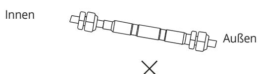
Mit Schallschutzfolie umwickeln, um Geräusche zu vermeiden
