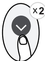
L'unità funzionerà ad alta velocità della ventola (mentre il compressore è acceso) con la temperatura impostata automaticamente a 8 °C/46 °F.
