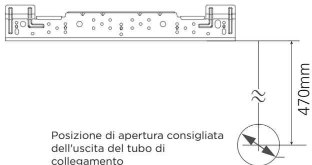
**Requisiti di fissaggio del tubo di drenaggio**
