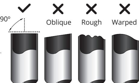
**Fig. 7.2****Step 2: Remove burrs.**
