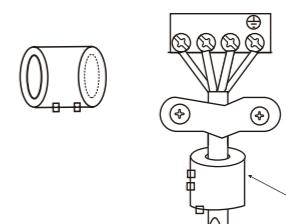
Treceti cablul prin inelul magnetic pentru a-l fixa.
