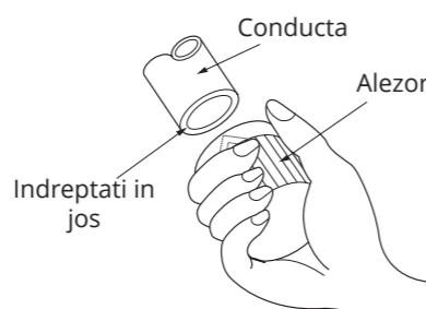
**Fig. 7.3****Step 3: Expansiunea capatului conductei**
