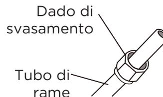
4. Rimuovere il nastro PVC dalle estremità del tubo quando è pronto per eseguire il lavoro di svasamento.
