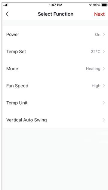
Seleziona Power (Alimentazione): On, Impostazione Temperatura: 22 °C, Modalità: Riscaldamento e velocità della ventola: Su livello alto. Premere Next (Avanti) per continuare
