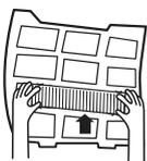
4. Atasati filtrul standard de aer (Necesita instalare)
