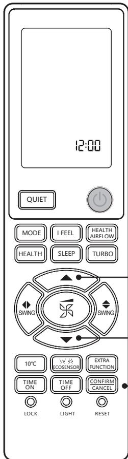
**1.** Setzen sie die Batterien ein oder drücken Sie Taste "RESET".
