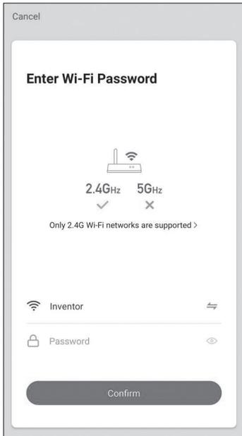
**Fase 4:** Selezionare la rete Wi-Fi e inserire la password. Premere Confirm per procedere. Il processo di accoppiamento può richiedere un certo tempo. **Nota:** l'indicazione di accoppiamento sul display del condizionatore d'aria potrebbe scomparire durante questa fase.
