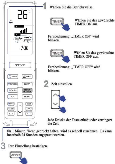
Nachdem die korrekte Uhrzeit eingestellt wird, drücken Sie die Taste APPLY zu bestätigen „ON“ oder „OFF“ auf der Fernbedienung hört auf zu blinken.
