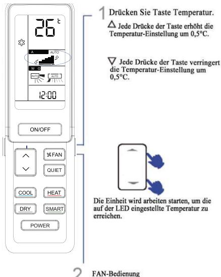
Die Einheit wird arbeiten starten, um die auf der LED eingestellte Temperatur zu erreichen.
