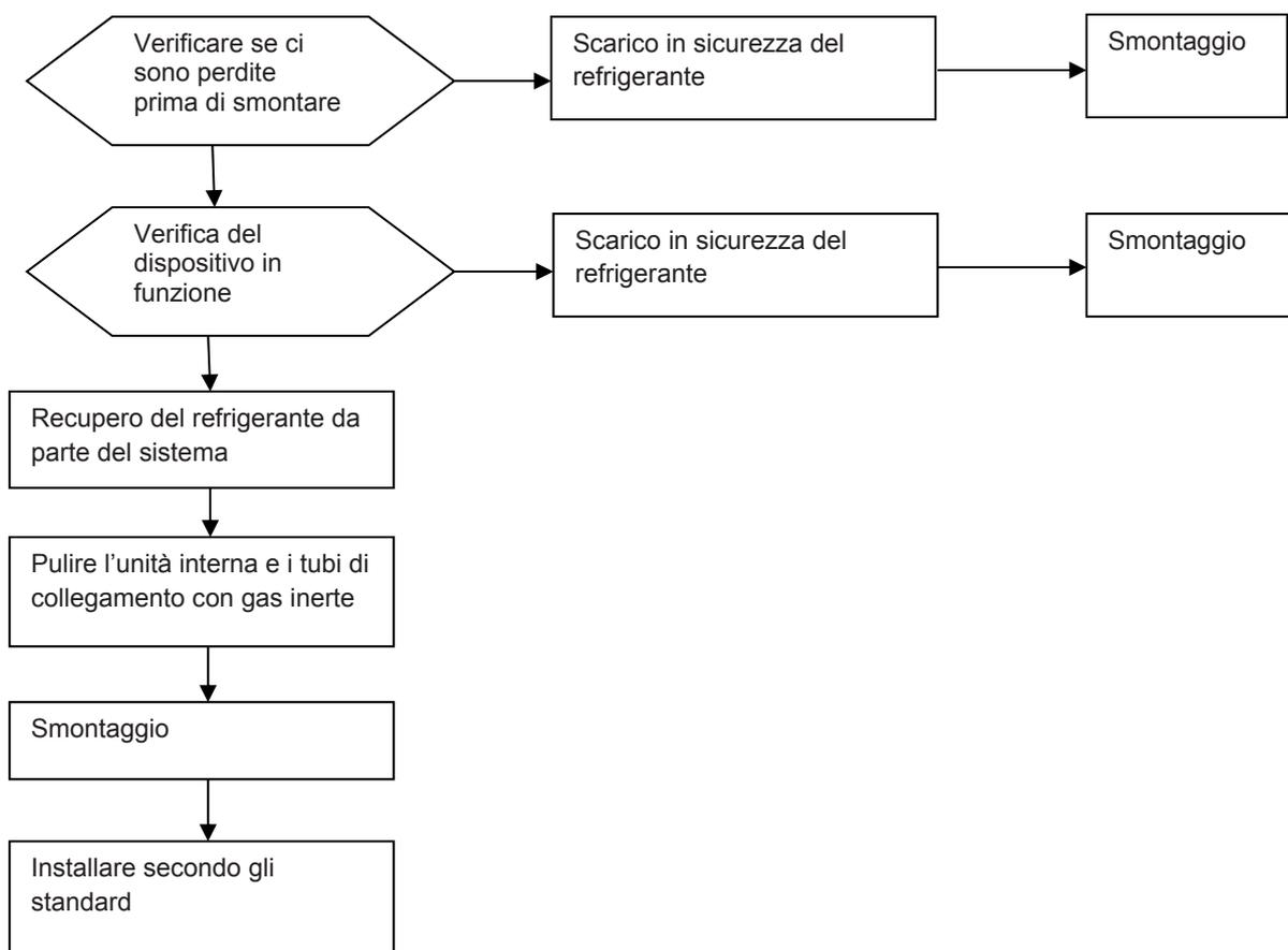
Attenzione: Se serve spostare il condizionatore, tagliare il giunto dei tubi gas/liquido dell'evaporatore dell'unità interna con una fresa. Il tubo va svasato (cartellato) ex novo: ripristinare il collegamento solo dopo averlo fatto (vale la stessa prescrizione per l'unità esterna).
