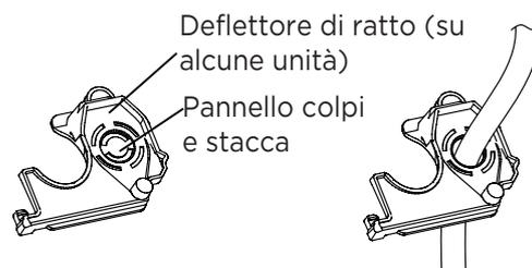
**NOTA:** Se la dimensione del cavo è troppo grande, rimuovere il piccolo pannello colpi e stacca di plastica centrale per creare una fessura attraverso la quale il cavo può uscire. Se si desidera rimuovere il telaio o il tubo di scarico, rimuovere prima il deflettore del ratto.
