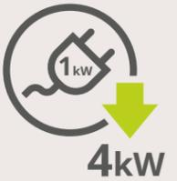
Die Luft/Wasser-Wärmepumpen sind sehr leistungsfähig, da sie mehr Energie erzeugen, als sie für ihren Betrieb benötigen. Konkret übertragen sie 4 kW Energie aus der Umwelt in den Raum und verbrauchen dabei nur 1 kW Strom. Der Wärmetauscher nimmt Energie aus der Umwelt auf, während der eingebaute Kompressor die Temperatur des Kältemittels (R32) erhöht und so für ein ideales Raumklima sorgt.
