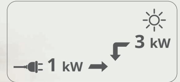
Die Wärmepumpen nutzen 1 kW elektrische Energie und 3 kW thermische Energie, die durch die Luft übertragen wird.
