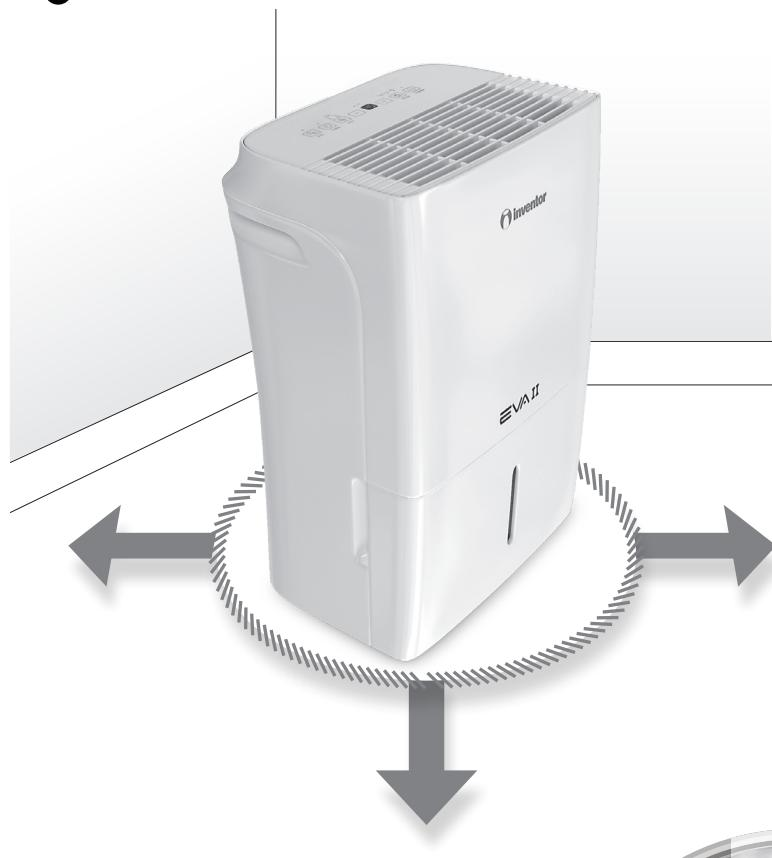
1) Ne bloquez ni ne restreignez le flux d'air autour de l'appareil. Assurez-vous que les grilles d'échappement de l'entrée d'air ne sont pas obstruées. Autoriser 30 cm de dégagement autour de l'appareil.
