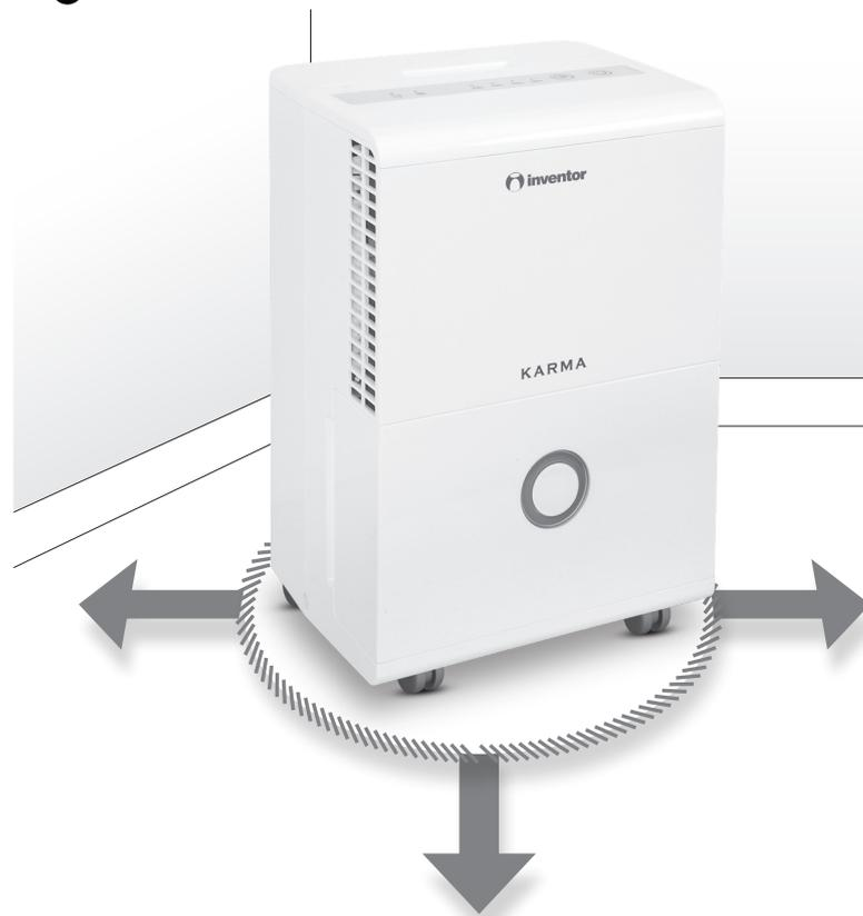
1) Ne bloquez ni ne restreignez le flux d'air autour de l'appareil. Assurez-vous que les grilles d'échappement de l'entrée d'air ne sont pas obstruées. Laissez 20cm libres autour de l'appareil et 40cm au-dessus de celui-ci.
