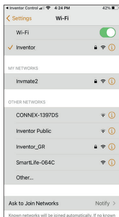
Pasul 7: Din setarile dispozitivului mobil, conectati-va la reseaua „SmartLife-XXXX” a dezumidicatorului. Reveniti in aplicatie si apasati „Urmatorul”.
