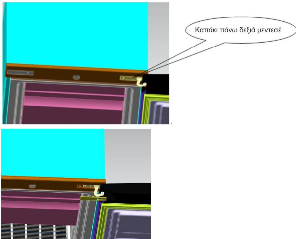
2) Ξεβιδώστε τις βίδες του πάνω μεντεσέ χρησιμοποιώντας το κατσαβίδι τύπου Philips.
