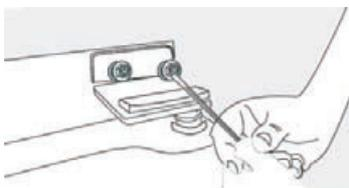
2. Scoateți cele 2 șuruburi fixate pe balama
