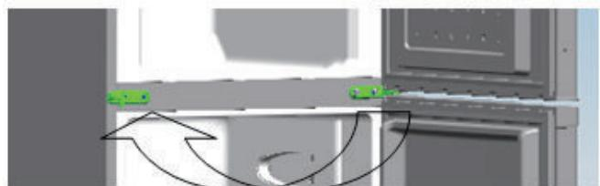
8) Τοποθετήστε τη κάτω πόρτα στη σωστή θέση και στερεώστε τον μεντεσέ.
