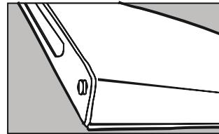
5) Entfernen Sie die beiden Schrauben von der oberen Halterung und ersetzen Sie sie auf der anderen Seite. Sie müssen zuerst die Kunststoffkappen von der anderen Seite entfernen.
