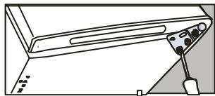
7) Vor dem Festziehen des Scharniers, Stellen Sie sicher, dass die Tür horizontal und vertikal so ausgerichtet wird, dass die Dichtungen an allen Seiten geschlossen sind.
