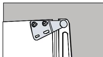
6) Schieben Sie die Gerätetür wieder auf das obere Scharnier, so dass es Sie sicher, dass sie positioniert ist. Schrauben Sie das untere Scharnier an seinem Platz auf der neuen Seite. Setzen Sie den anderen Fuß auf der anderen Seite wieder ein. Setzen Sie die Kunststoffabdeckung wieder ein, indem Sie sie zurück in die richtige Position auf das Türscharnier anklicken.
